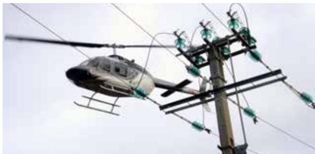
À partir de 2018, GÉRÉDIS surveille le réseau des lignes moyenne tension (20 000 volts) du département par des survols en hélicoptère équipés de la technologie Lidar ou *Light Detection and Ranging*, un appareil de télédétection (mesure de distance) par laser.
